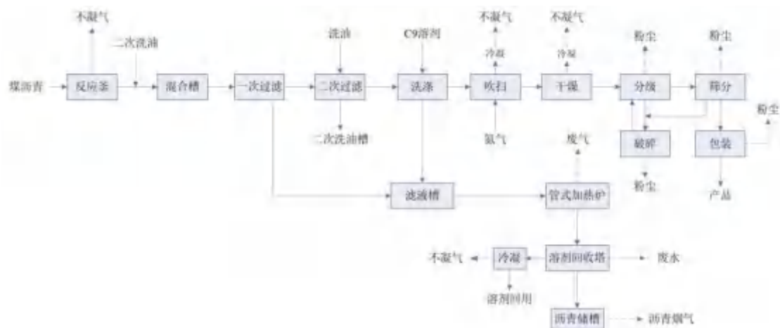
图 2.1-15 现有中间相炭微球项目工艺流程及产污环节示意图
